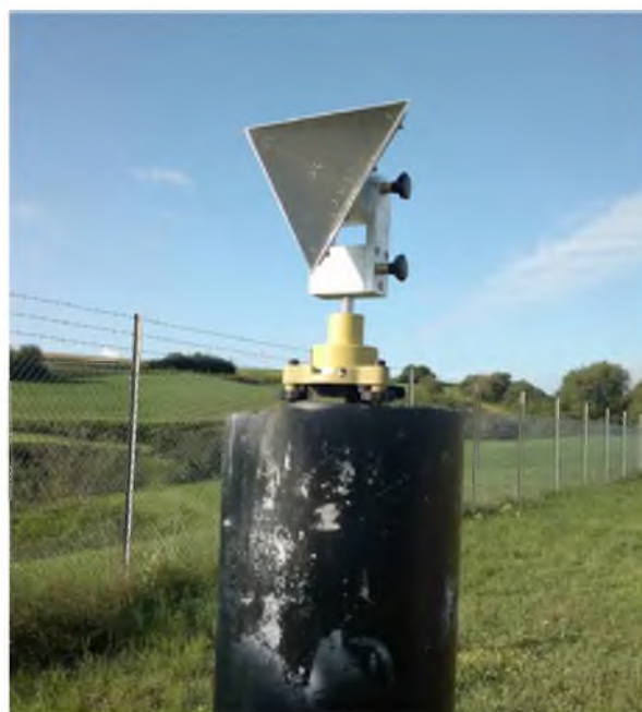
Рис.2. Рефлектор, установленный над геодезическим пунктом на полигоне твердых бытовых отходов
