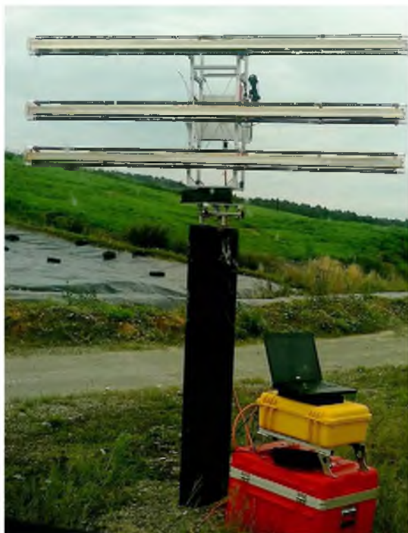
Рис.1. Мониторинг рекультивационных работ наземным радарным интерферометром GPRI-2 на полигоне твердых бытовых отходов
