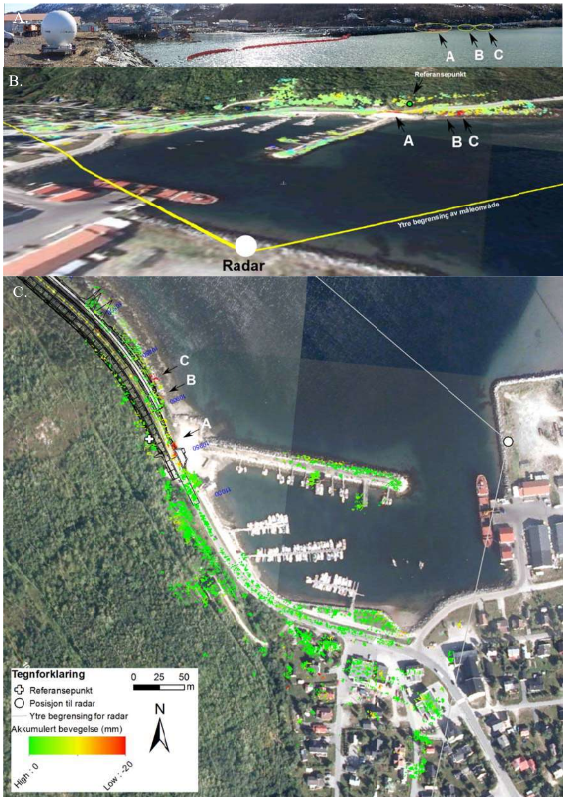
Fig. 5. A. Panorama som viser områder med særlig stor bevegelse (A–C). Sørkjosen sentrum til venstre i bildet. B. 3D-visning av akkumulert bevegelse i løpet av 1,1 døgn med målinger i radars sikteretning. C. Kartprojeksjon av akkumulert bevegelse.
